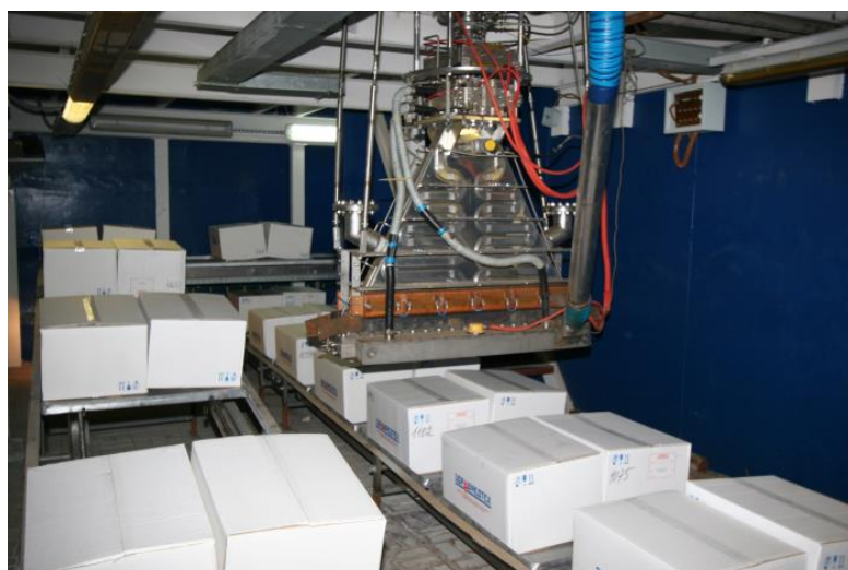
Рис. 7. Ускоритель ИЛУ-10 (сверху) и его выпускное устройство над конвейером (снизу), Институт ядерной физики, Новосибирск.
