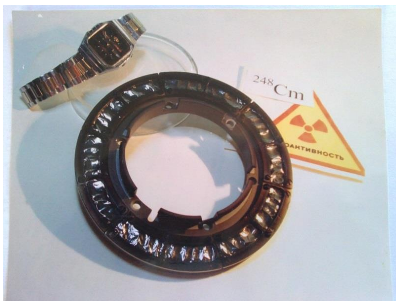
Рис. 3. Мишенный модуль для синтеза сверхтяжелых ядер:
