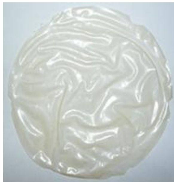
Рис.5. Образец пленки после прививки, R_g = 200\%
